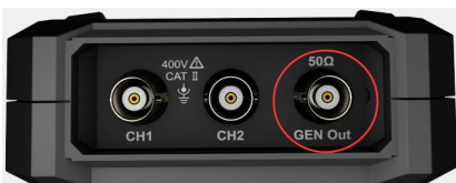
Рисунок 5.1. Выходной разъем генератора сигналов
