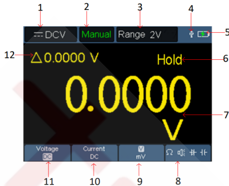
Рисунок 4.1. Интерфейс дисплея в режиме мультиметра
